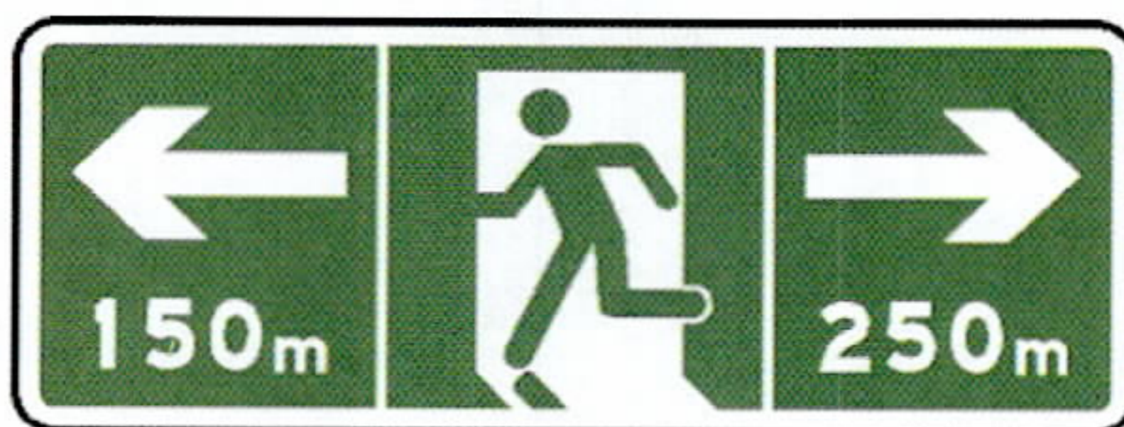
图 A.0.5 疏散指示标志版面示意图
