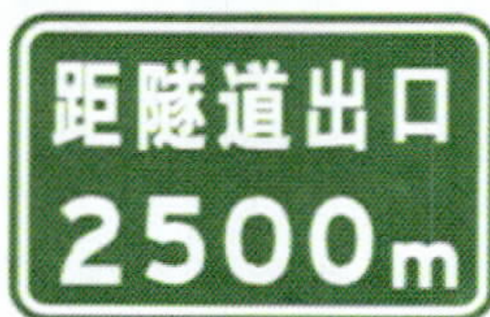
图 A.0.6 隧道出口距离预告标志版面示意图
