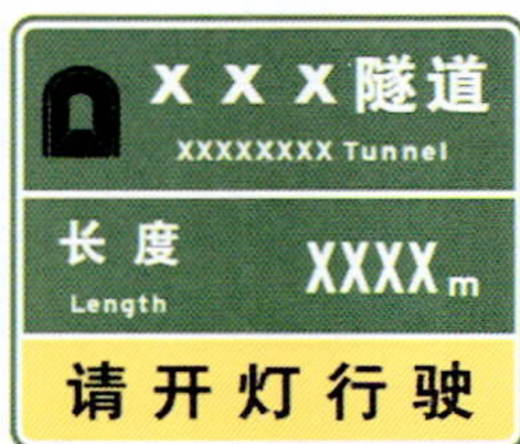
图 A.0.1 隧道信息标志版面示意图
