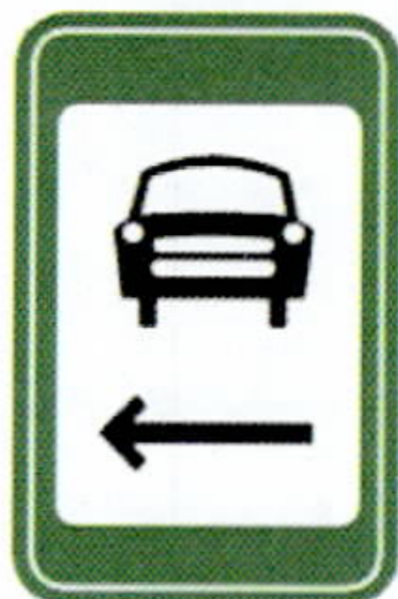
图 A.0.4 车行横通道指示标志版面示意图
