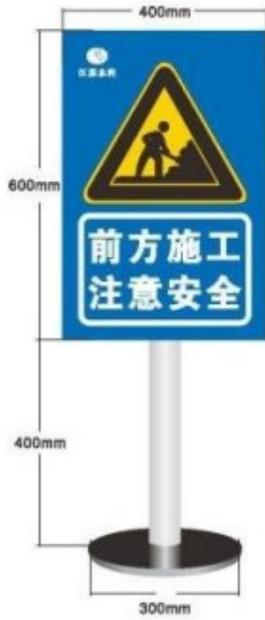
图E.4 落地式支持安装方式示意图
