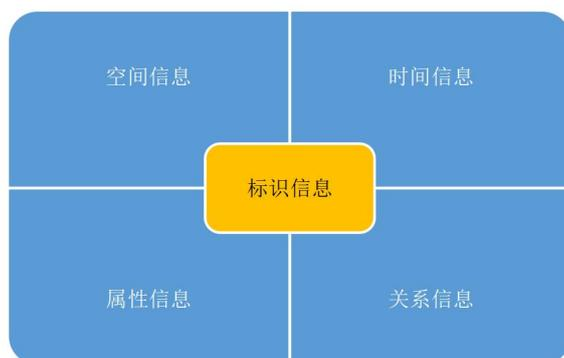
图 1 基础地理实体的概念模型
