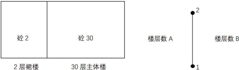
图 A. 1 建筑楼层分界线实体构建
