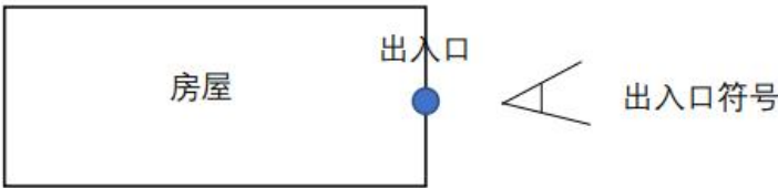
图 A. 3 出入口点实体构建方式
