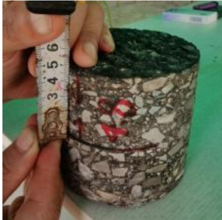
图 15 试验路现场取芯
