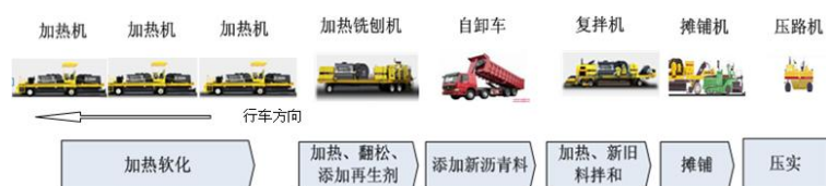
图 1 传统就地热再生大型机组施工流程
