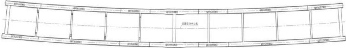
图 B.1 钢主梁上翼缘分块方案图
