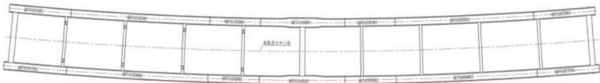
图 B.2 钢主梁下翼缘分块方案图
