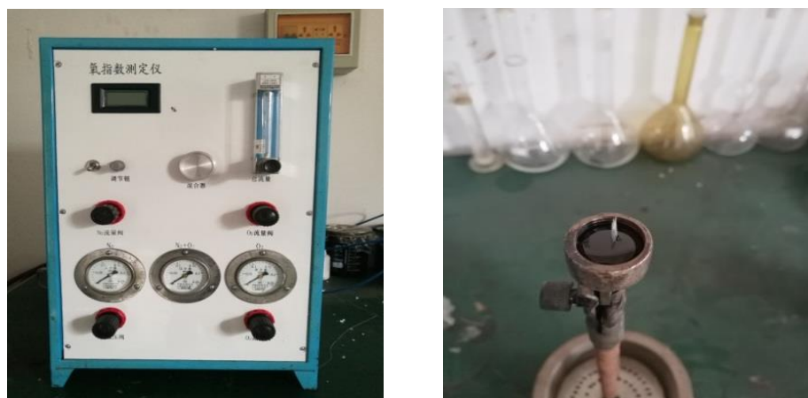
图 2 极限氧指数仪及杯形试样燃烧状态
