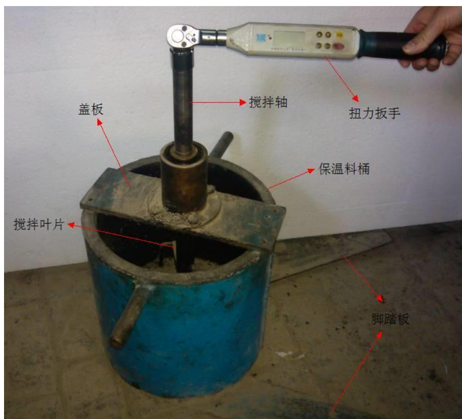
图 3 沥青混合料和易性测试仪
