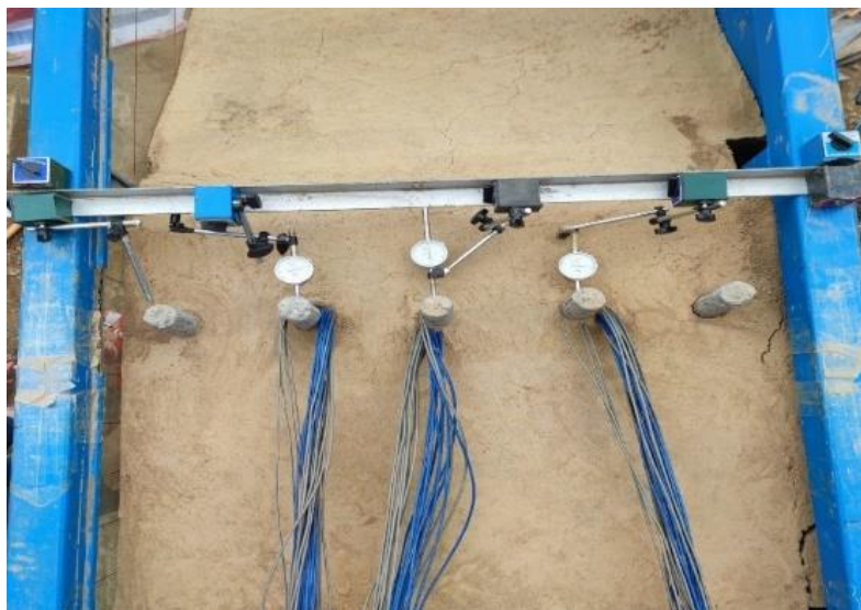
图3 微型抗滑桩模型试验
