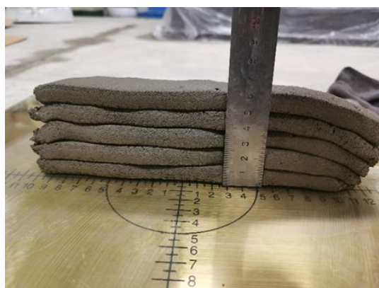
图 3-4 砂浆堆积保留率测试
