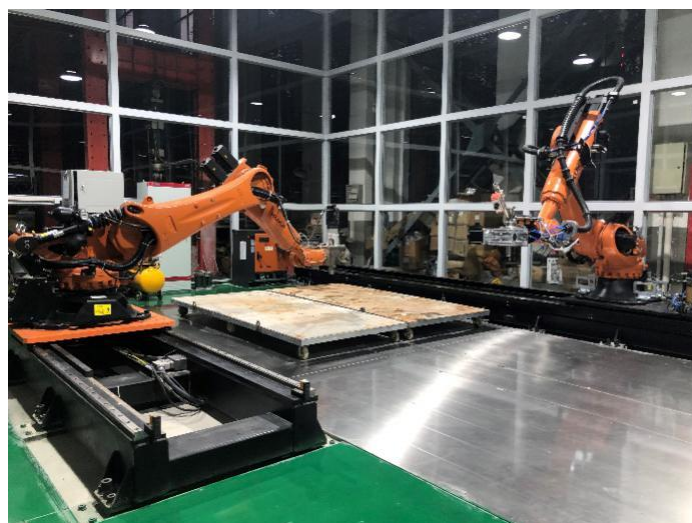
图 3-5 机械臂 3D 打印设备
