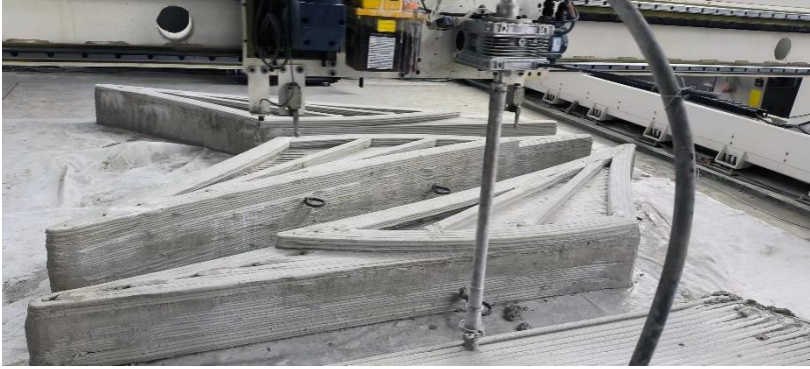
图 3-12 侧墙打印测试
