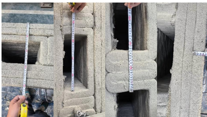
图 3-15 打印构件尺寸测量
