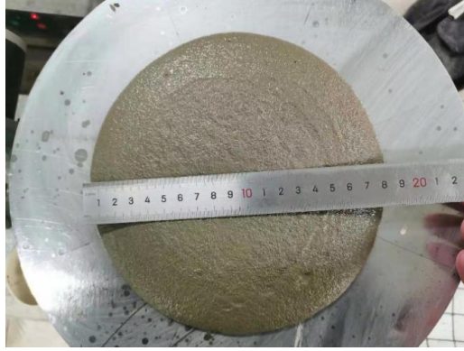
图 3-1 胶砂流动度测量
