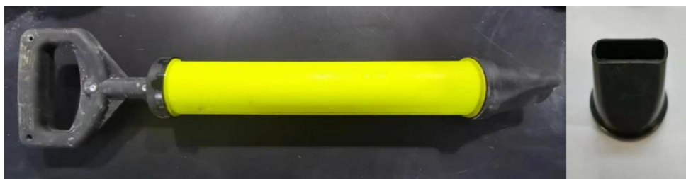
图 3-3 砂浆挤出堆积用胶枪
