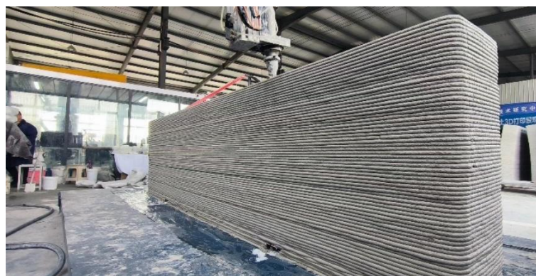
图 3-11 主拱圈打印测试
