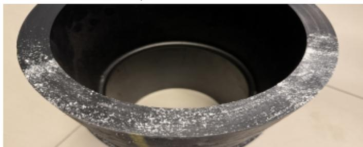
图 D.2 微粒污染（滑石粉）施加
