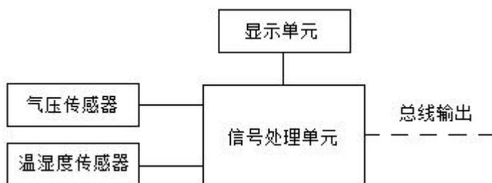
图 1 测量装置结构示意图
