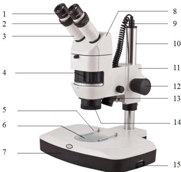
图2 双目镜金相显微镜的外形图
