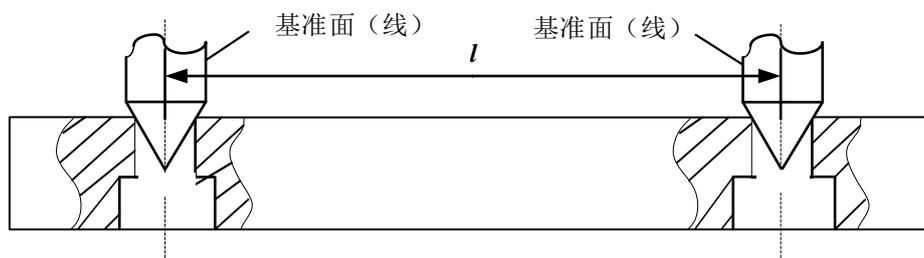
图8 圆锥测头中心距卡尺测量示意图
